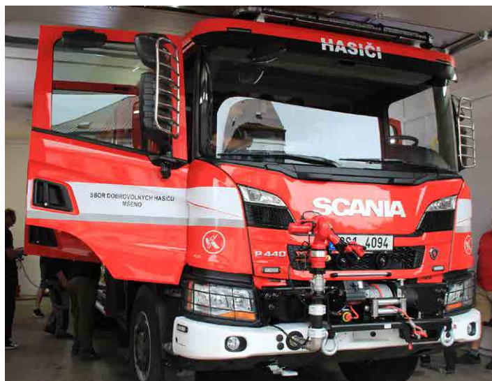
Nový vůz disponuje nárazníkovou proudnicí ovládanou z kabiny řidiče.
