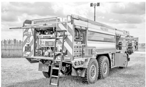
Cisterna je vybavena osvětlovacím stožárem.
